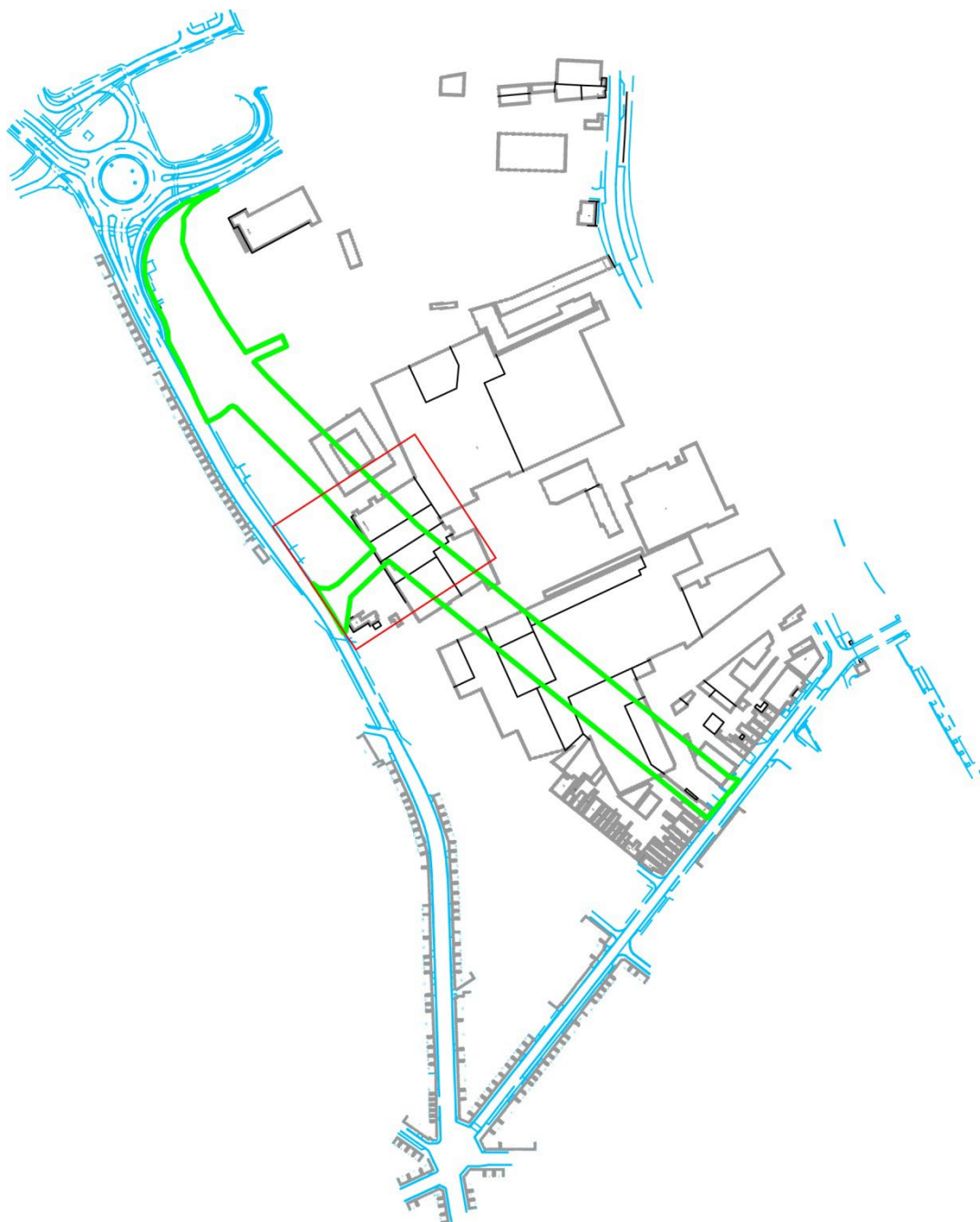
Figuur 65: plan van de bestaande toestand met aanduiding van de wegkoffer (groen) en de veronderstelde locatie van het kerkhof (rood)
